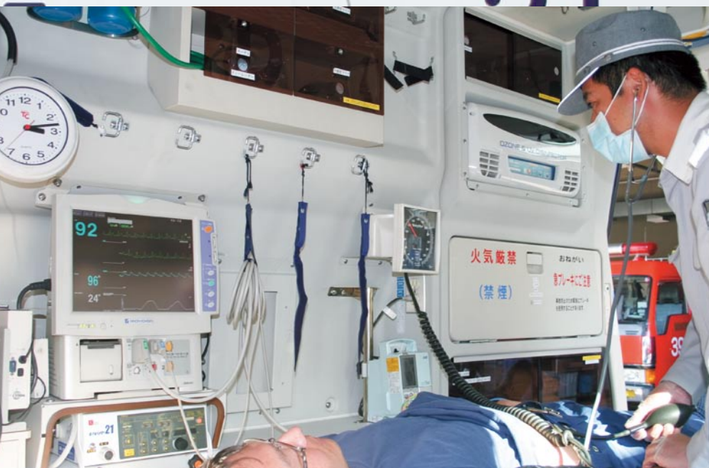
▲ 普段なかなか見ることができない救急車の内部。血圧計や心電図など、様々な計器が整然と配置されている。
