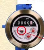
自宅のすべての蛇口を閉め、水道メーターのパイロットマークが回っている場合、漏水している可能性があります。水道メーターは一般的に玄関付近の地面などに埋設されています。
