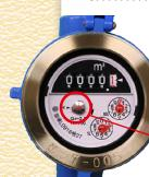
自宅のすべての蛇口を閉め、水道メーターの**パイロットマーク**が回っている場合、漏水している可能性があります。水道メーターは一般的に玄関付近の地面などに埋設されています。
