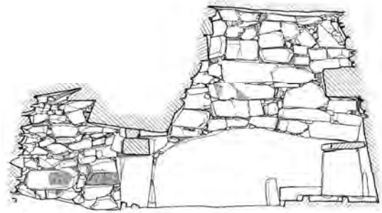
図 16：壁の破損箇所
